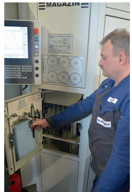
5 Flexibilität bei kurzen Rüstzeiten: Das 180 Werkzeuge fassende Standby-Magazin ergänzt das 50 Werkzeuge große und mit-fahrende Hauptmagazin; Hubert Biglmaier zeigt, wie einfach eine hauptzeitparallele Bestückung des Magazins ist (© Hanser)
