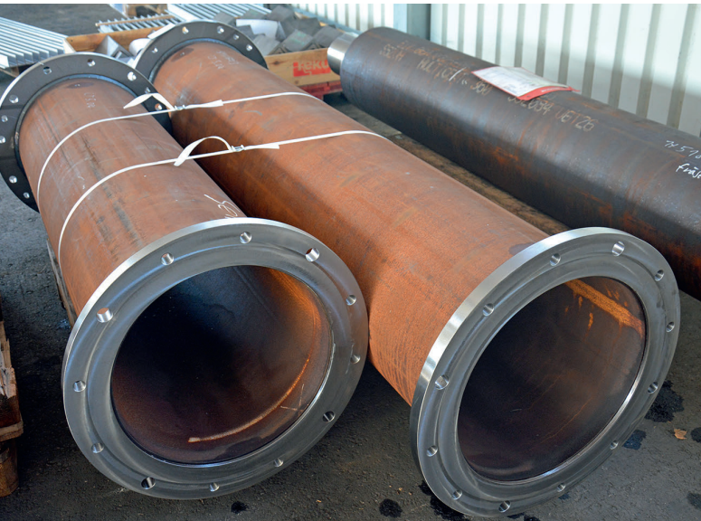
4 Rohrständer mit angeschweißten Flanschen und bis zu 3,6 m Länge werden bei Seifert auf der Tiltenta auch stirnseitig bearbeitet – bei hoher Fluchtgüte der eingebrachten Bohrungen und Gewinde (© Hanser)
